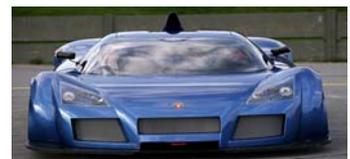
Der Gumpert Apollo hat einen 4.2-I-V8-Biturbo Motor mit 700 PS. Der Wagen ist auch mit 650 oder 800 PS erhältlich. Er beschleunigt von 0 auf 100 in 3 Sekunden. Von 0 auf 200 in mickrigen 8.9 Sekunden. Seine unglaubliche Höchstgeschwindigkeit ist 360 km/h. Er schafft bis 4500 U/min.
